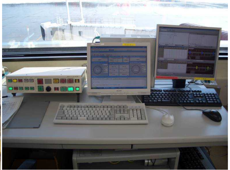
運用カテゴリ表示操作盤(左)、空港気象表示(中央)、滑走路面監視装置表示(右) (管理事務所3階)
